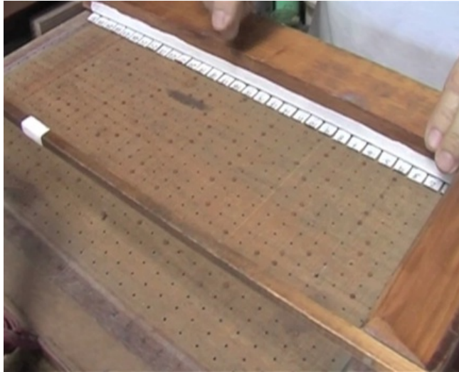
Figura 5 – Dispositivo de programação manual inventado por Abraham Palatnik em 1951. Foto de Marjolaine Beuzard, 2007.
