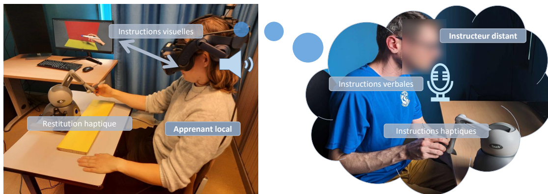
FIG. 1 – Illustration de l'étude expérimentale. Pensant qu'il interagit en temps-réel avec un instructeur distant, l'apprenant reçoit des instructions pré-enregistrées concernant l'amplitude d'un mouvement à reproduire en utilisant quatre combinaisons différentes de modalités : verbale-visuelle, verbale-haptique, visuelle-haptique et verbale-visuelle-haptique. Il tente ensuite de reproduire ce mouvement le plus fidèlement possible.
