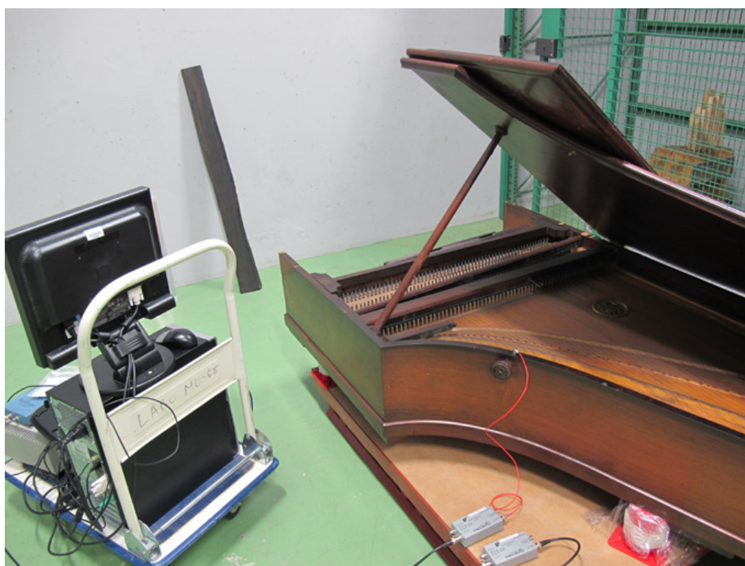
Figure 6 Enregistrement sur un clavecin suspecté d'être infesté par des xylophages avec le système ATAX ® . © Cité de la musique-Philharmonie de Paris.
