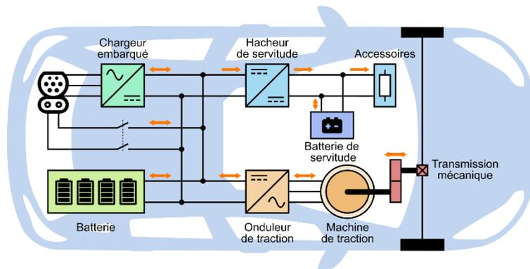
Figure 3 : Schéma synoptique d'un véhicule électrique conventionnel
