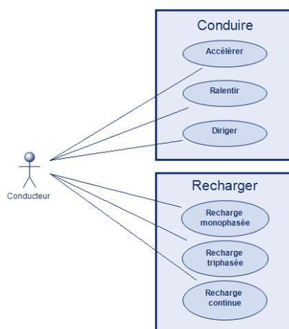
Figure 2 : Diagramme des cas d'utilisation d'un véhicule électrique
