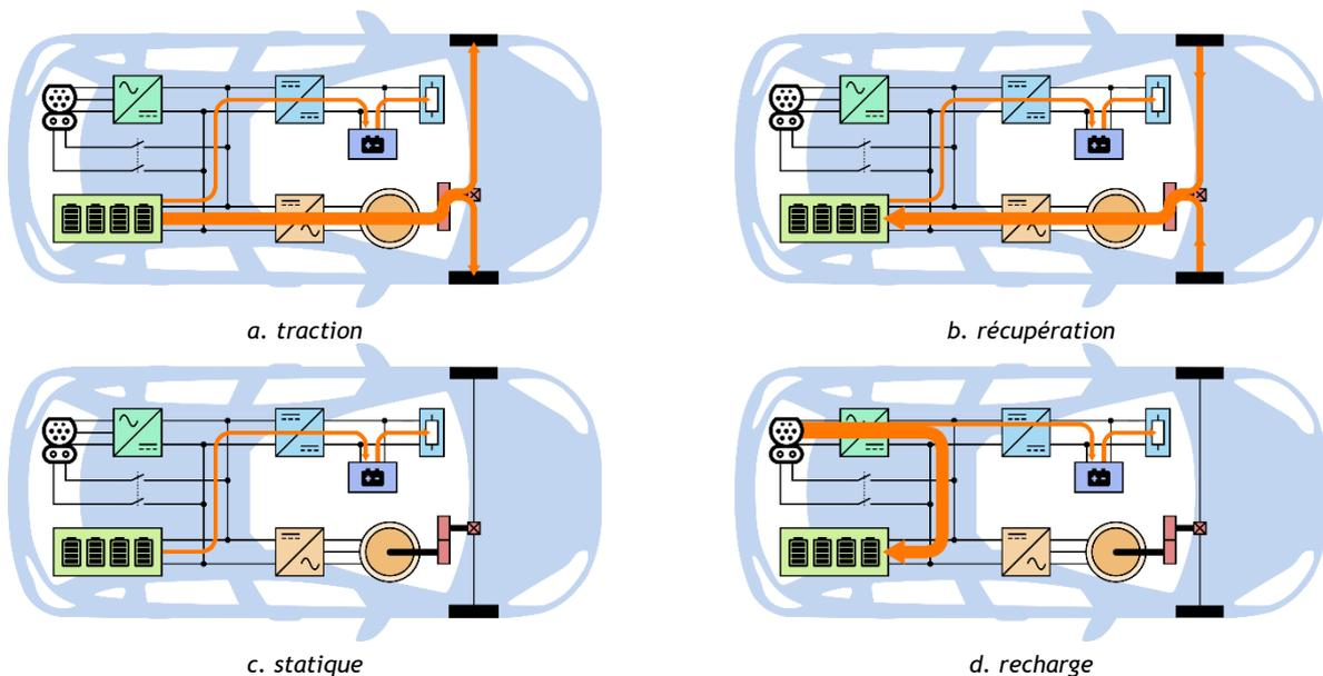
Figure 4 : Transferts de puissance dans différents modes d'utilisation
