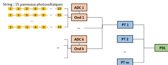
FIG. 1 – Schéma simplifié d'une CP au sol
