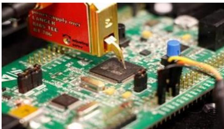
Cryptographie post-quantique (PQC) pour garantir la sécurité d'informations face à des attaques d'injection de perturbations contrôlées par un ordinateur quantique. © CEA
