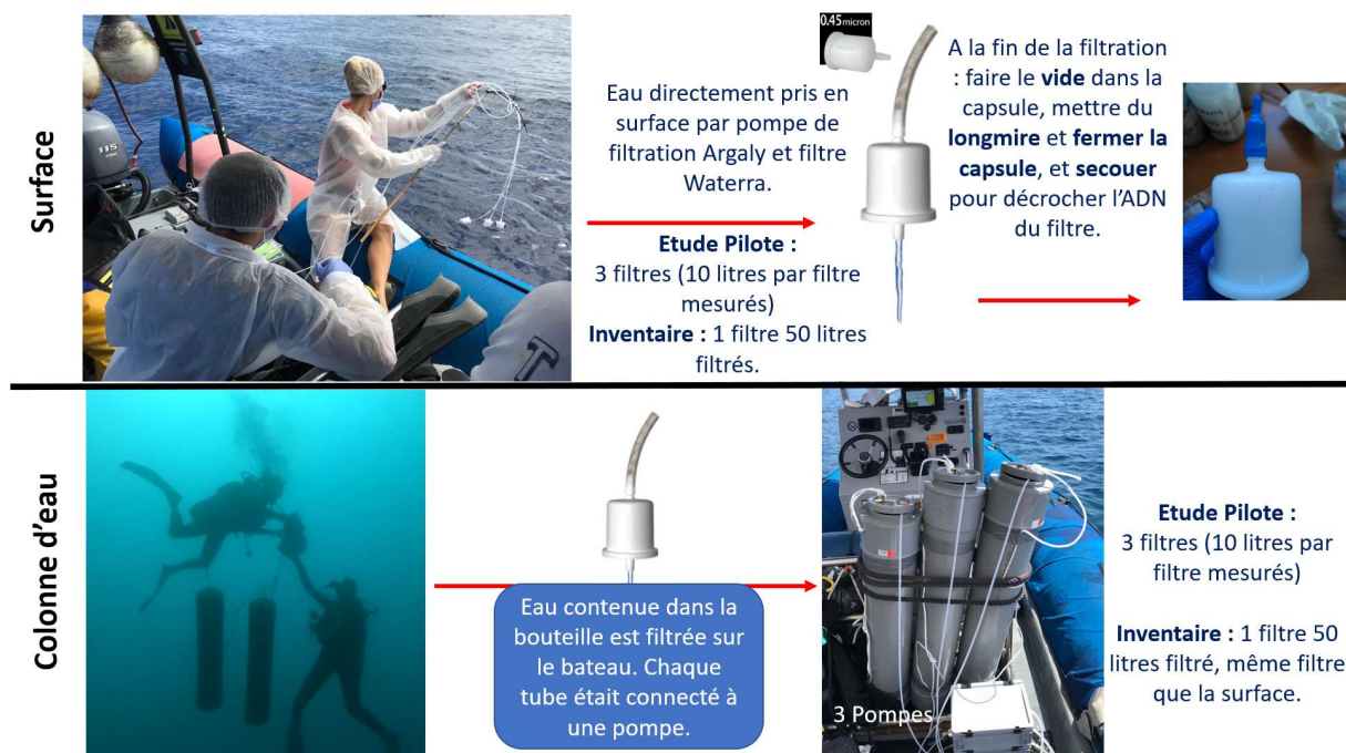
Figure 2. Protocole de filtration en mer à partir d'un filtre Waterra, d'une pompe ARGALY, et du kit ARGALY comprenant un tuyau, des bouchons bleus pour fermer le filtre, une solution longmire et une seringue pour mettre la solution dans le filtre (voir Annexe 1 pour le détail du protocole technique).
