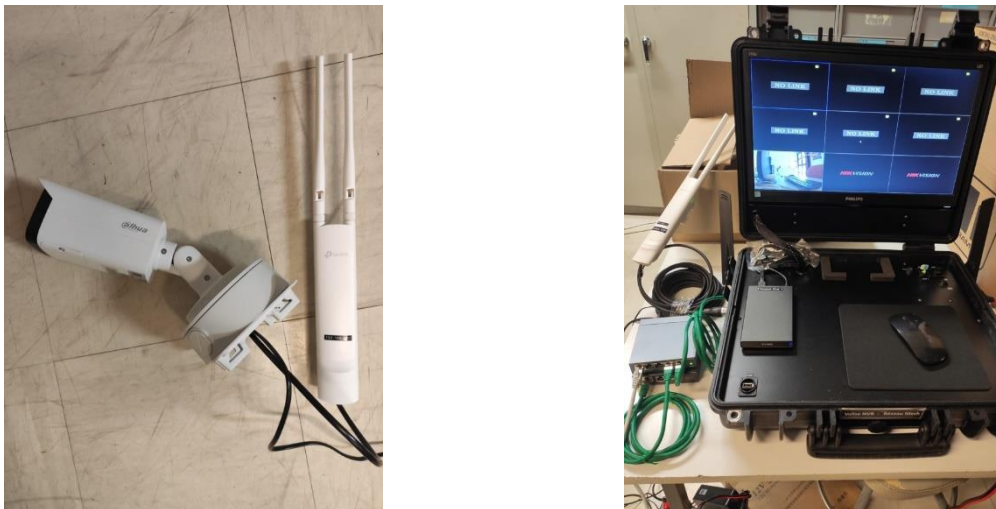
Figure 3. Illustration des caméras utilisées sur le site (image à gauche) ainsi que la valise qui contient le système de stockage (image à droite) des vidéos du site de l'Oncopole.
