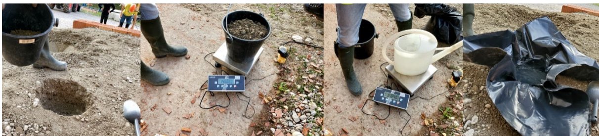
Figure 3.9 Détermination du poids volumique par essai à la bêche. De gauche à droite : (1) Extraction d'une quantité de sol au le sommet du remblai, (2) Pesage du matériau, (3) Pesage initial de l'eau à verser dans l'excavation pour remplacer le sol retiré et (4) Remplissage du trou d'excavation.
