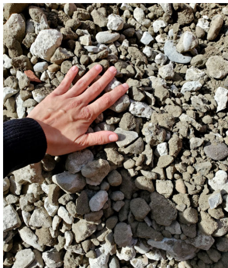
Figure 2.1 Matériau livré sur le site d'essai : taille maximale des particules et propreté
