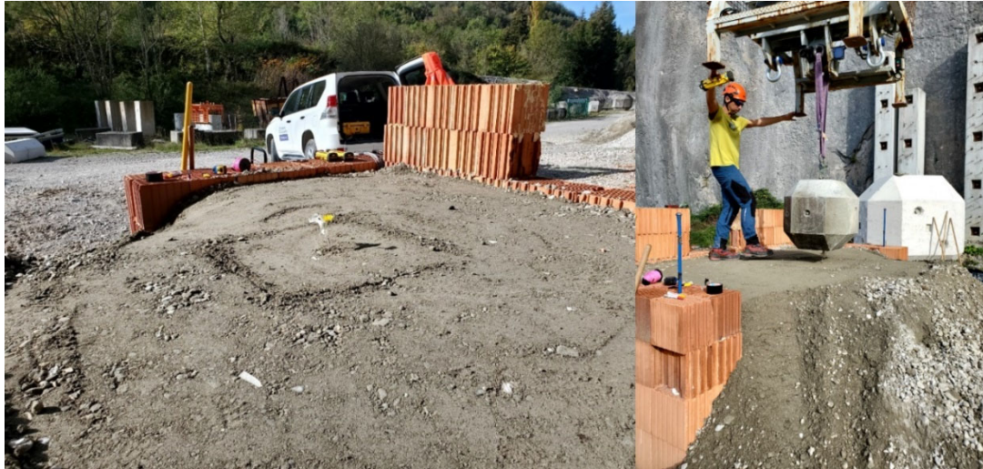
Figure 3.11 A gauche, repérage du point d'impact visé et, à droite, alignement de l'impacteur
