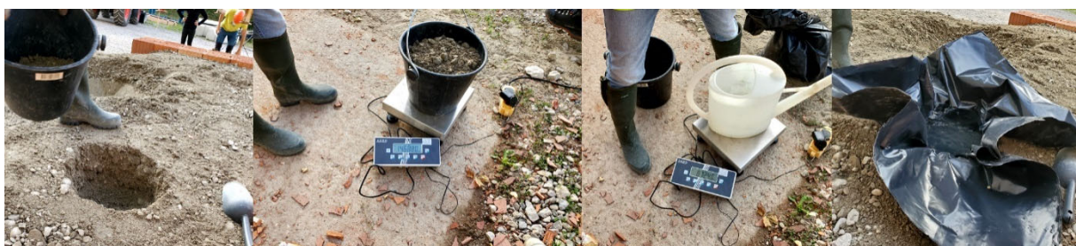
Figure 3.9 Détermination du poids volumique par essai à la bêche. De gauche à droite : (1) Extraction d'une quantité de sol au le sommet du remblai, (2) Pesage du matériau, (3) Pesage initial de l'eau à verser dans l'excavation pour remplacer le sol retiré et (4) Remplissage du trou d'excavation.
