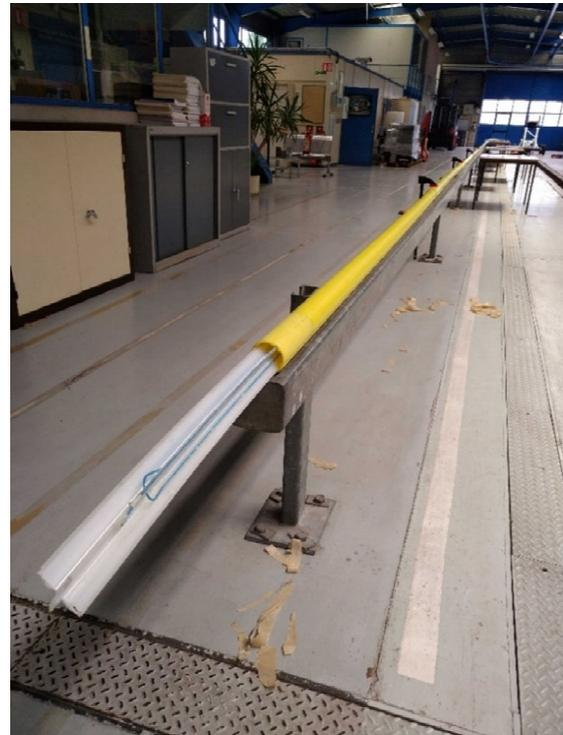
(a) Tronçon de profilé support des fibres optiques (b) Tube inclinométrique équipé du dispositif
