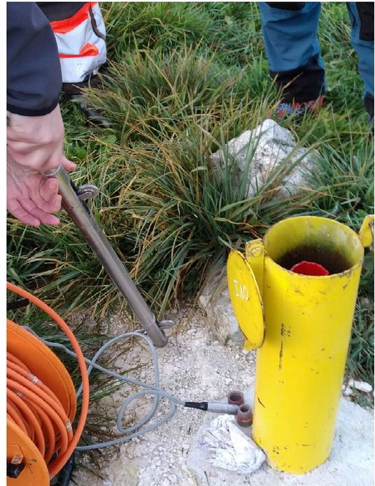
(b) Relevé inclinométrique du tube I10
