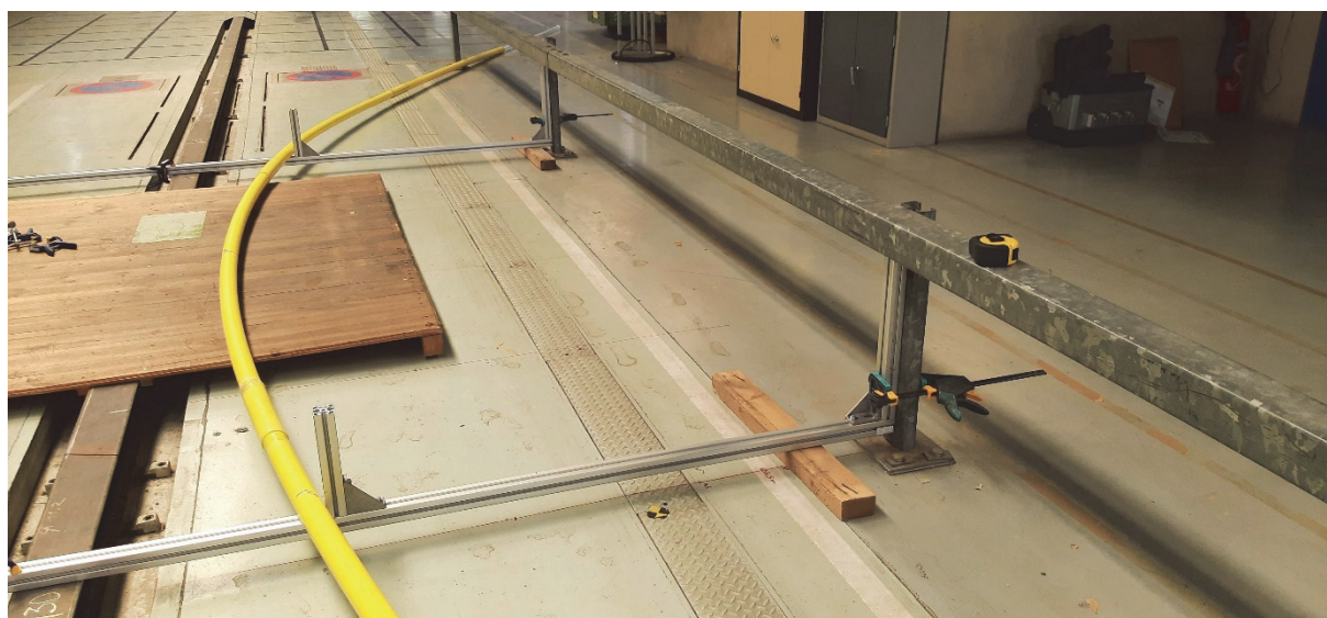
Figure 5.4. Détail du dispositif d'essai en flexion plane quatre points
