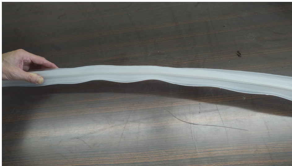
Figure 3.4. Flambement des ailettes produit par un enroulement du profilé sans précaution
