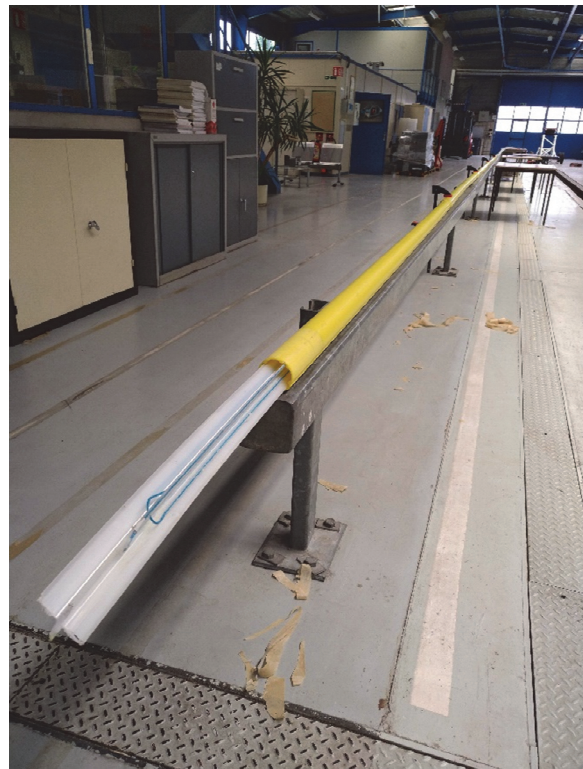
(b) Tube inclinométrique équipé du dispositif
