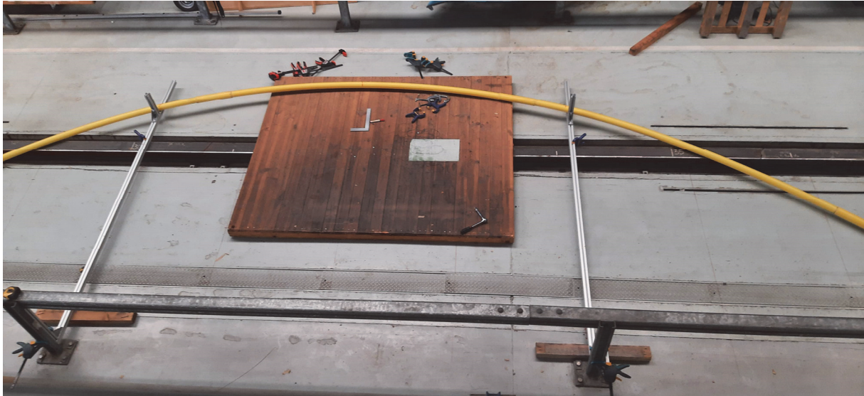
Figure 5.5. Détail du dispositif d'essai en flexion plane quatre points – Flèche imposée maximale
