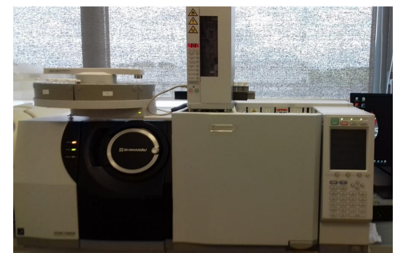
Shimadzu GC-2010 plus couplé à la spectrométrie de masse TQ8040
