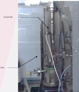
Pilote ultrasons UIP1000hd, Hielscher Ultrasonics, GmbH.
