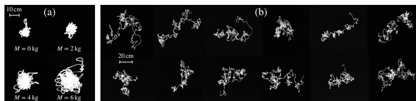
FIGURE 1. Trajectoires d'un pointeur laser, obtenues en demandant à une personne de viser une cible le bras tendu (a) les yeux ouverts et (b) les yeux fermés.
