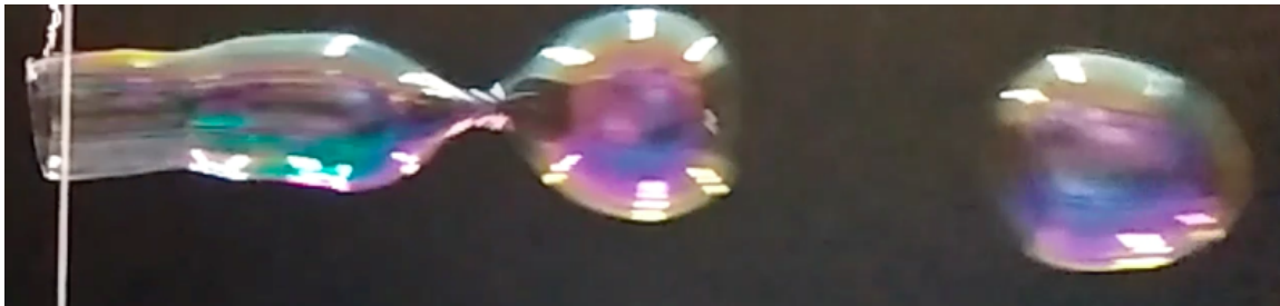
FIGURE 1. Photographie de la poche de savon à l'aval de laquelle des bulles se détachent de manière périodique.
