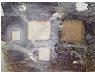
Fig. 11-12. TT 33. Résultats obtenus par microgommage (projection de particules fines) avec de l'oxyde d'alumine à 220 mesh/pression \leq 2 bars, sur une surface de cassure dans la salle II avec différents réglages. Comparaison avec un test chimique réalisé à droite (S. Duberson).
