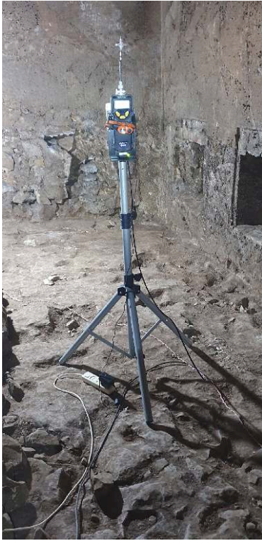
Fig. 22. TT 33. Mesure COV en temps réel : l'appareil (PPB RAE 3000) fixé sur pied permet la mesure et l'enregistrement des valeurs en ppb des COV présents dans le caveau (J. Le Roux, F. Boyer).
