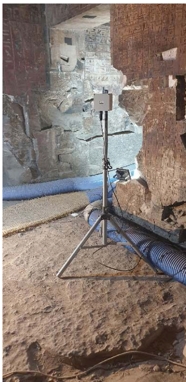
Fig. 21. TT 33. Mesure climatique en temps réel : quatre capteurs fixés sur pied et installés dans différentes salles transmettent en temps réel à un ordinateur, les valeurs de température et d'humidité relative sous forme de chiffres et de courbes (J. Le Roux, F. Boyer).
