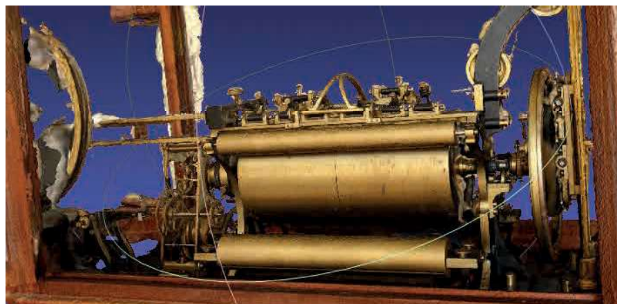
Figure 7. Premier modèle 3D du mécanisme du marégraphe.
