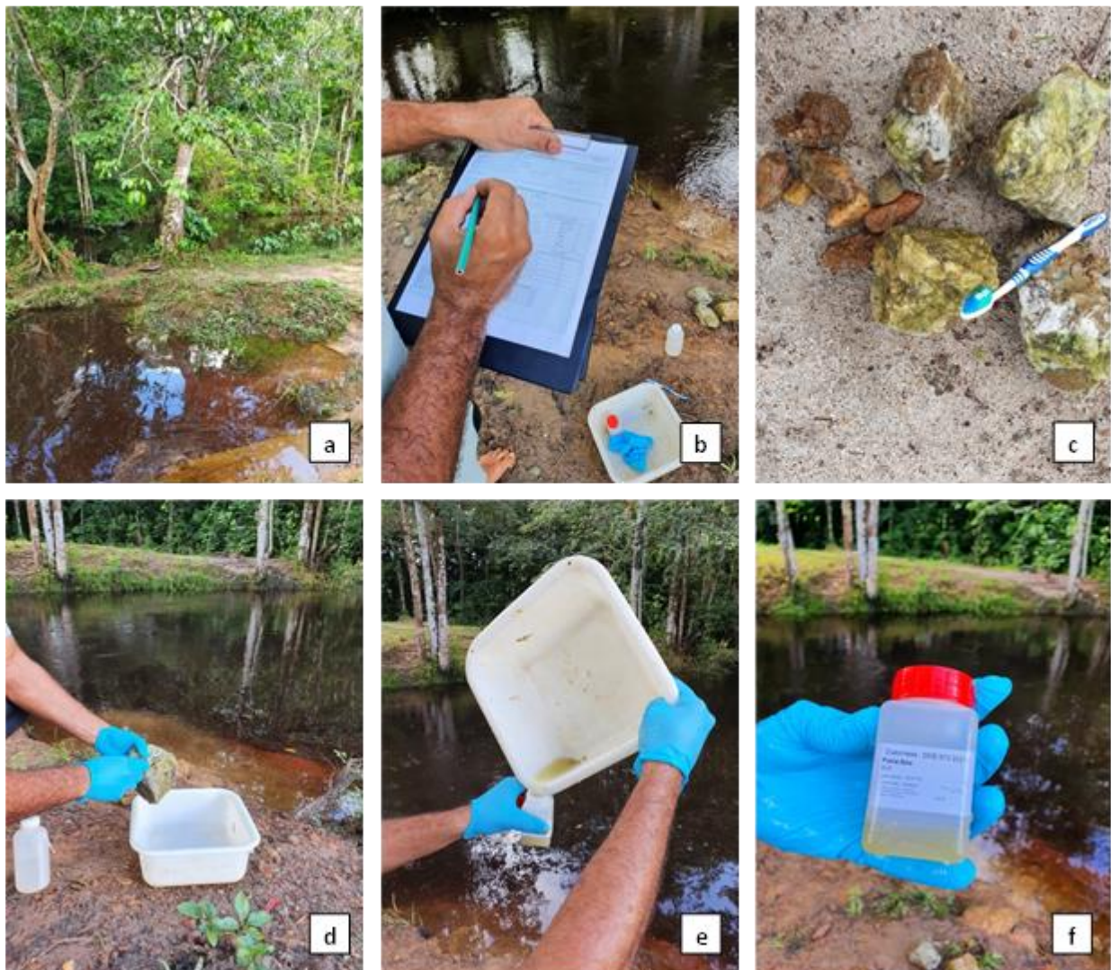
Figure 19 : Prélèvement sur le terrain des échantillons de diatomées (Crédit photos : Julian Frédéric, HYDRECO)
