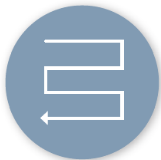
Figure 25 : Balayage de la lame par transects horizontaux (extrait de la Norme NF T 90-354 d'avril 2016 modifiée)
