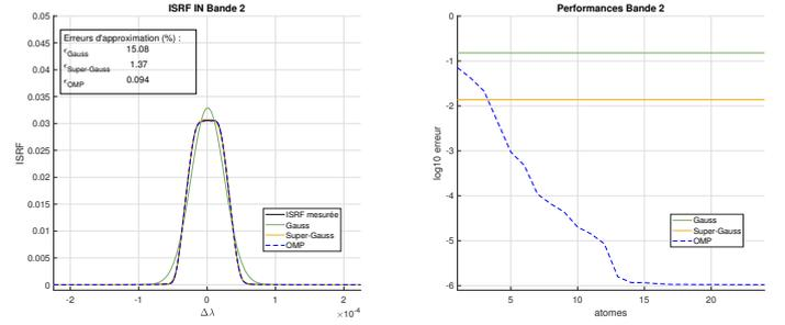
FIGURE 1 : Approximations de l'ISRF issues des modèles Gauss, Super-Gauss et OMP avec les erreurs associées.
