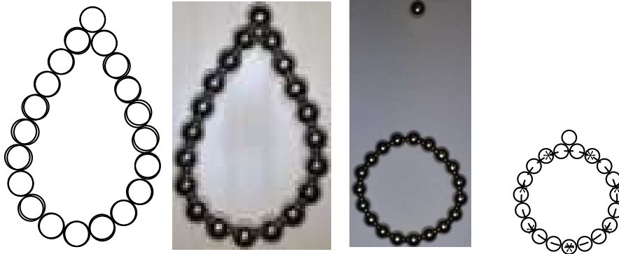
FIGURE 1. La larme, de gauche à droite : superposition des cercles expérimentaux et calculés, photographie de la larme expérimentale (d'où sont issus les cercles expérimentaux) ; configuration expérimentale initiale menant à une larme ; configuration numérique initiale (avec les points de contrôle des splines indiqués par des étoiles (*)).
