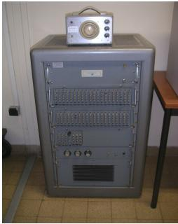
Icophone: Système de synthèse par diphonèmes à partir du texte utilisant un banc de 44 oscillateurs, résultant des travaux menés en collaboration entre le LIMSI (J.S. Liénard, D. Teil), le LAM (M. Castellengo, E. Leipp) et le LMP (J. Sapaly). L'Icophone V fut commercialisé en deux exemplaires par TITN.
