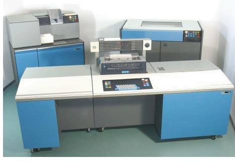
IBM 1130 utilisé dans les années 70 pour les recherches en Traitement Automatique de la Parole au LIMSI, alors dirigé par L. Malavard. On distingue l'unité centrale, le lecteur de cartes et l'imprimante. Le banc de filtres et le synthétiseur de parole Icophone lui étaient connectés. Pour le système de compréhension de la parole continue ESOPÉ (J. Mariani, 1978), l'IBM 1130 était connecté à un IBM 370/168, fonctionnant en temps partagé, situé au CIRCÉ (à présent IDRIS), centre de calcul du CNRS.
