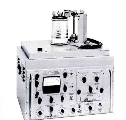
Les premiers travaux en analyse de la parole au LIMSI ont amplement utilisé le sonographe de Kay Elemetrics donnant une représentation fréquentielle, en bande large ou en bande étroite, de la parole (spectrogramme). D'un maniement complexe, le résultat était donné sur du papier spécial placé sur un rouleau. Il fut remplacé par des logiciels comme UNICE réalisé par J.L. Gauvain et diffusé par Vecsys en 1989.
