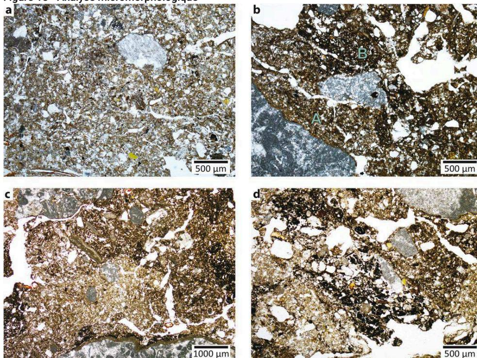
a : fine porosité fissurale subhorizontale (MM5, US 26', Ums 25, MPol, LPNA) ; b : gradient d'altération thermique à la base du foyer, (A) brunification modérée de la masse sédimentaire et (B) brunification homogène (MM 5, US 26', Ums 22, MPol, LPNA) ; c et d : distribution aléatoire de fragments brûlés et non brûlés bien accommodés (MM5, US 26', Ums 19, MPol, LPNA)
