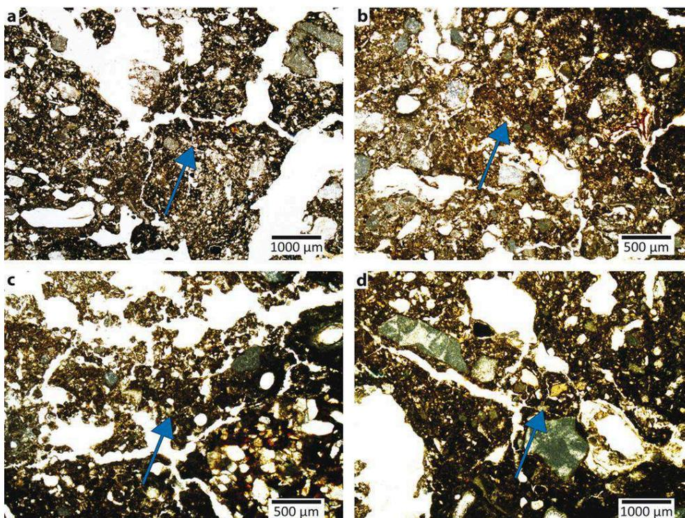
a : croûte structurale argilo-limoneuse (MM7, US 11, Ums 10, MPol, LPNA) ; b : croûte structurale basculée (MM5ht, US 15, Ums 11, MPol, LPNA) ; c : croûte structurale discontinue (MM5ht, US 15, Ums 10, MPol, LPNA) ; d : sables grossiers et esquilles d'os au sommet de rejet (MM5ht, US 15, Ums 7, MPol, LPNA)
