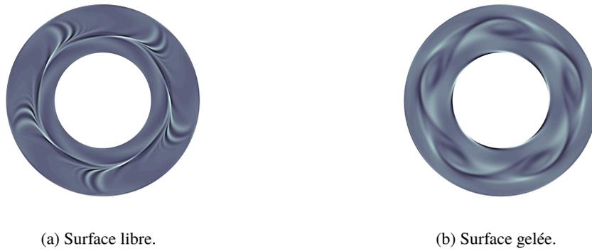
FIGURE 6: Comparaison de la vorticité axiale  $\omega_z$  à la surface, pour  $Re = 95$ .
