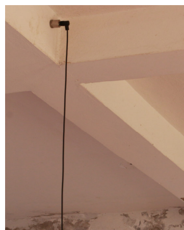
Figures 4.3 et 4.4 : ancienne école St e Geneviève à Petit-Canal (Guadeloupe) et un des accéléromètres utilisés fixé sur l'une des deux poutres en croix d'une salle de classe.
