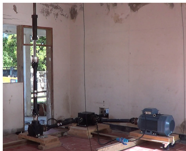
Figures 4.5 et 4.6 : balourds en rotation sur le toit de l'école et moteur (à gauche), arbres horizontaux, renvois d'angles et arbres verticaux dans une des deux salles de classe du rez-de-chaussée (à droite).
