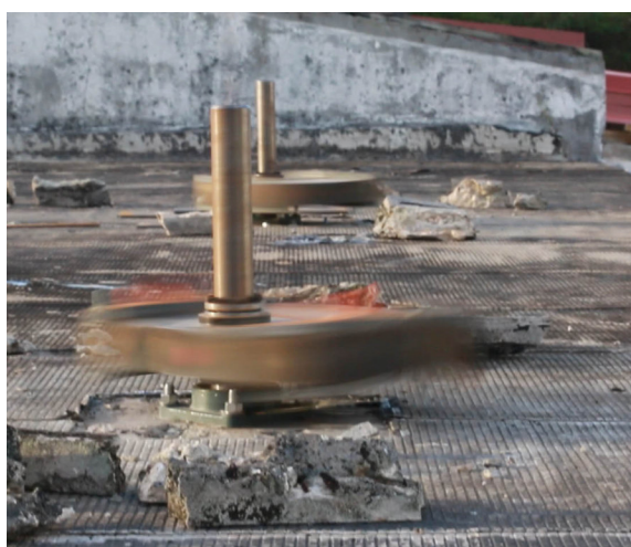
Figures 4.5 et 4.6 : balourds en rotation sur le toit de l'école et moteur (à gauche), arbres horizontaux, renvois d'angles et arbres verticaux dans une des deux salles de classe du rez-de-chaussée (à droite).
