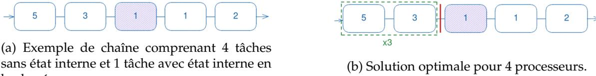
FIGURE 1 – Ordonnancement d'une chaîne sur 4 processeurs.
