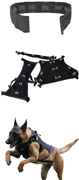
Figure 1 : Prototypes de ceinture et harnais tactiles.
