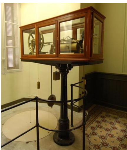
Figure 1 — Le marégraphe totaliseur (à gauche).
