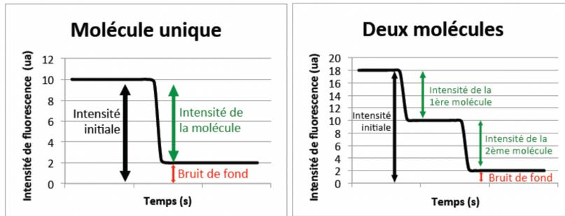
FIGURE 1 – Deux profils d'intensité lumineuse en théorie.
