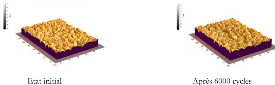
FIG. 8 - Mesures de texture au laser d'un BBTM(0-10) à l'état initial et après 6000 cycles
