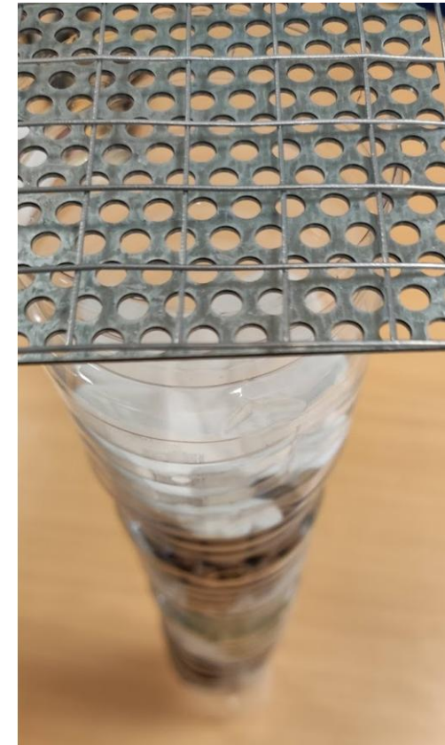
Dispositif artisanal de filtration de l'eau
