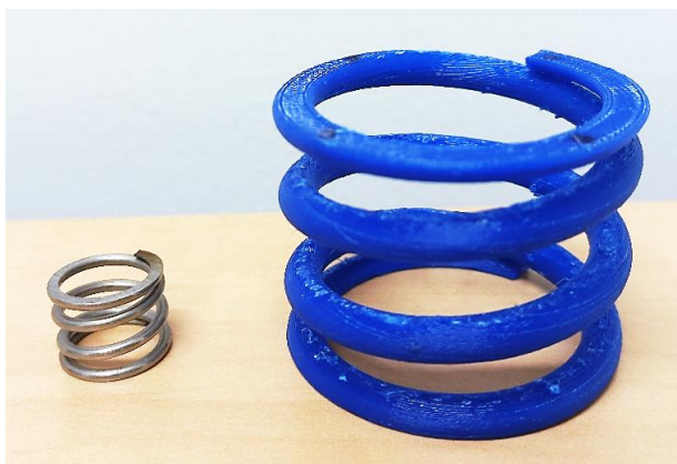
Figure 3 – Ressort métallique d'origine (à gauche) et sa réplique en impression 3D plastique aux dimensions triplées (à droite)
