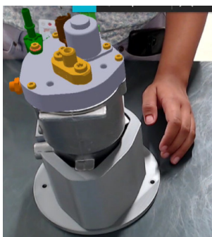
Figure 5 - Affichage des composants à monter sur le carter de la pompe Common Rail Delphi®
