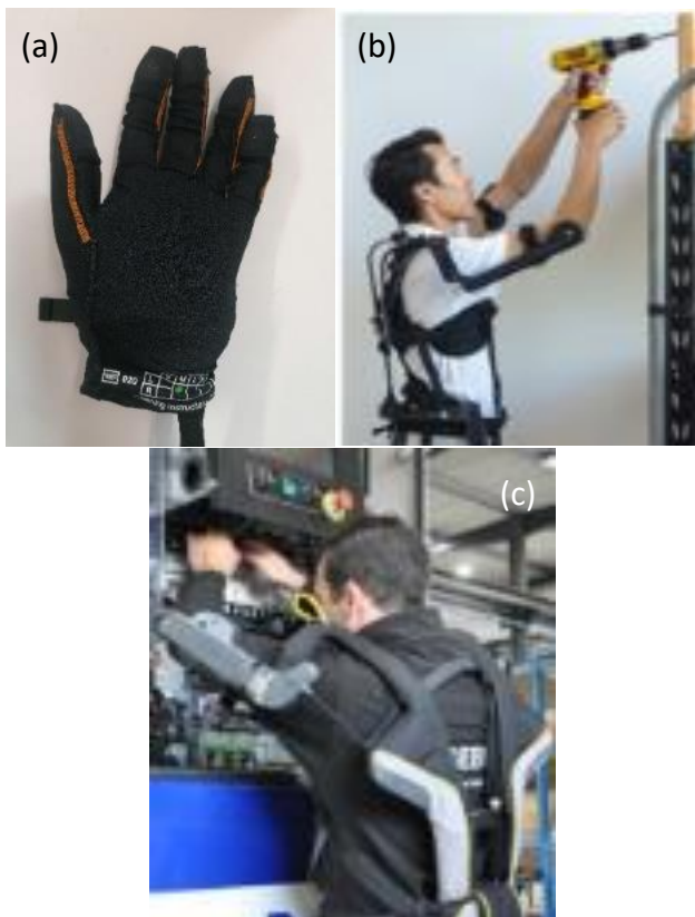
Figure 1 : quelques exosquelettes d'assistance aux gestes : Ironhand (objet de l'étude), SuitX, Ergosquelette de Gobio Robot
