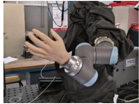
Figure 6 : Installation de la main sur un robot collaboratif
