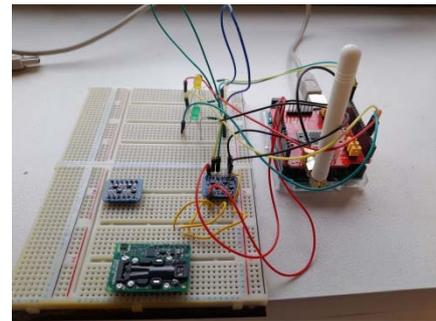
fig 7 : Capteur CO2 – connecté
