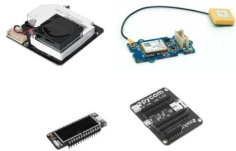
fig 4 : Capteur SCD30 , GPS Grove, Carte Lopy4
