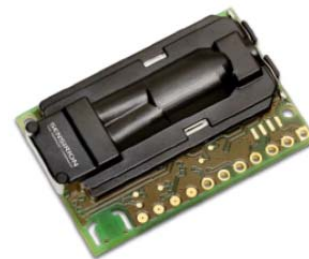
fig 3 : Capteur SCD30 , calibrable
