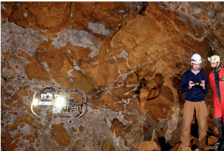
Figure 3 : Vol d'un drone Stereo2 de la société Multinnov lors d'un test de pilotage en zone profonde de la grotte Sainte-Catherine (Ariège). Notez la cage de protection, l'éclairage embarqué très puissant (12.000 lumens) et la caméra déportée en hauteur. Cliché S. Jaillet Flight of Stereo2 (Multinnov company) during a test to pilot in the deep zone of the Sainte Catherine cave (Ariège). Note the drone's cage, powerful embedded lights (12000 lumens) and the camera at the top of the UAV.
