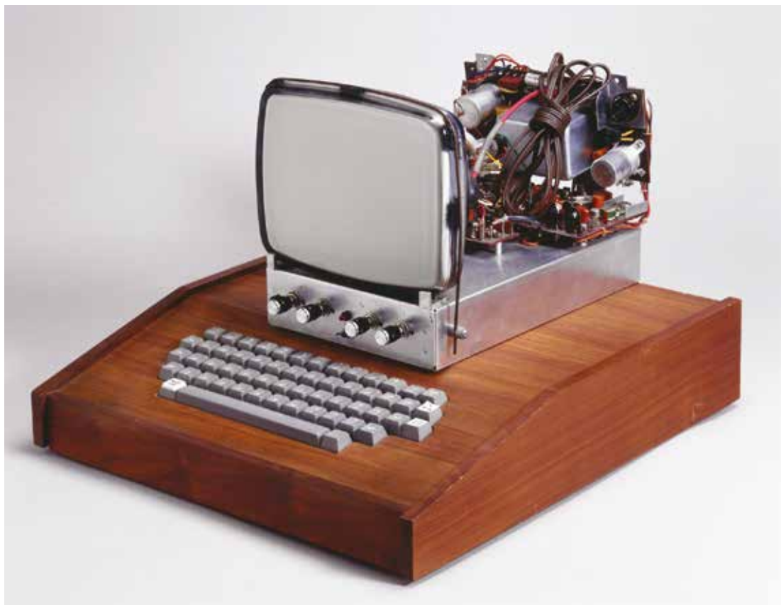
ORDINATEUR PERSONNEL, MODEL APPLE I, CONÇU PAR RON WAYNE, STEVE JOBS ET STEVE WOZNIAK, ET FABRIQUÉ PAR APPLE INC DE 1976 À 1979. SCIENCE MUSEUM GROUP COLLECTION
