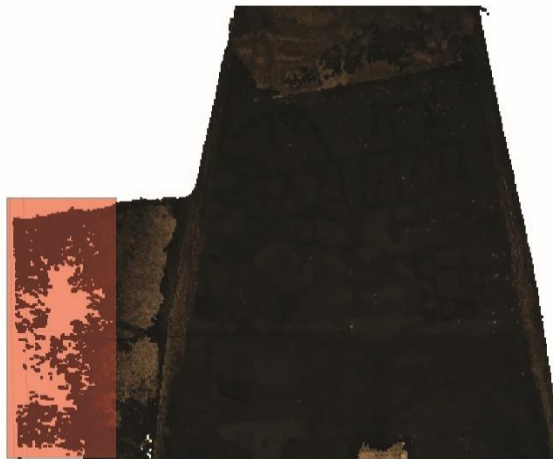
Figure 5 : Afin de nettoyer les nuages de points, les zones aux limites de l'acquisition sont filtrées le plus possible. Ici, la zone rouge correspond à un couloir qui ne figure pas dans les objectifs de l'étude. Cette zone comporte ainsi des manques particulièrement visibles, elle est donc supprimée.
