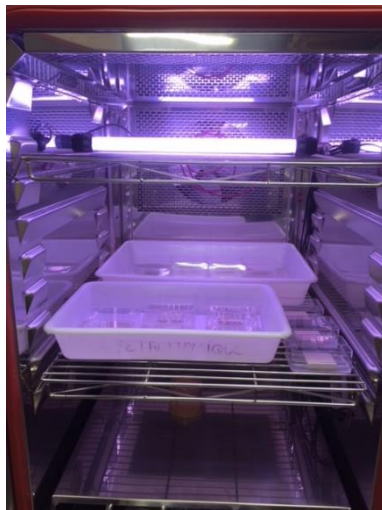
Figure 44 : Mise en place des tests biocides dans l'enceinte.
