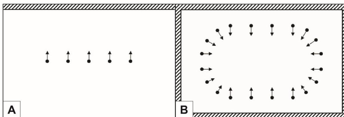
Figure 1 : Vue zénithale d'une procédure d'acquisition photogrammétrique. Le point représente la position du photographe, la flèche l'orientation de la prise de vue. A. Pour une façade ; B. Pour un intérieur. D'après Agisoft, 2021.
