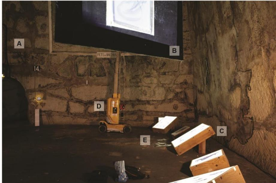
Figure 2 : Photo d'acquisition du modèle photogrammétrique de la cave de Bacchus. Un certain nombre d'éléments remarquables viennent gêner l'acquisition : A. Câbles aériens. B & C. Panneau d'exposition lumineux. D. Nacelle élévatrice. E. Réflexion de la lumière sur une flaque d'eau au sol.
