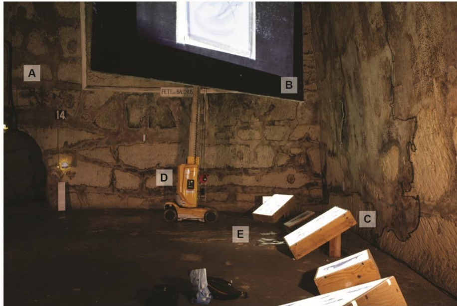
Figure 2 : Photo d'acquisition du modèle photogrammétrique de la cave de Bacchus. Un certain nombre d'éléments remarquables viennent gêner l'acquisition : A. Câbles aériens. B & C. Panneau d'exposition lumineux. D. Nacelle élvatrice. E. Réflexion de la lumière sur une flaque d'eau au sol.
