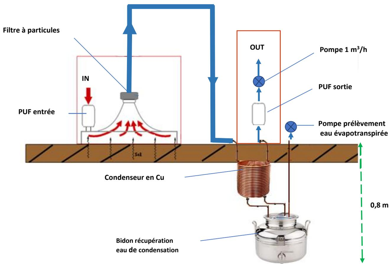
**Figure 5** : Fonctionnement de la chambre à flux : i) Collecte des émissions particulaires sur un filtre à particules, ii) Collecte de l'eau évapotranspirée par le sol et la végétation dans un bidon inox enterré, iii) Collecte des émissions gazeuses du sol par adsorption sur mousse en polyuréthane (PUF) en sortie (OUT). Une PUF en entrée (IN) assure une entrée d'air épuré dans la chambre.
