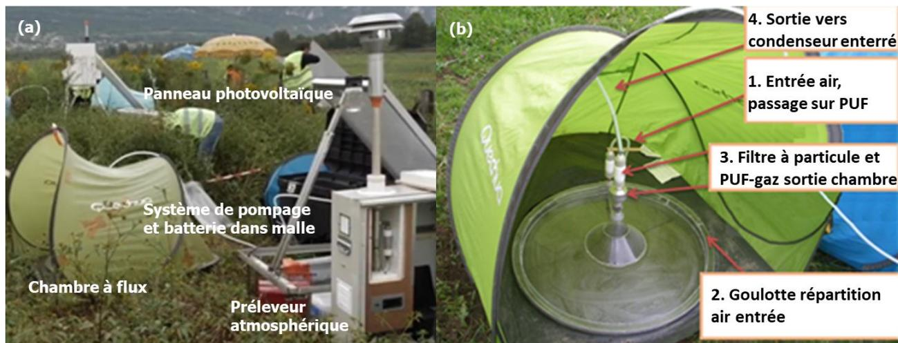
**Figure 6** : **a.** Implantation de la chambre à flux et du système de pompage sur site. **b.** Chambre à flux : surface au sol de 0,8 m<sup>2</sup>. Disposition sous tente pour une protection des intempéries. Le condenseur enterré est relié au système de pompage, mis également à l'abri dans une malle sous une autre tente.
