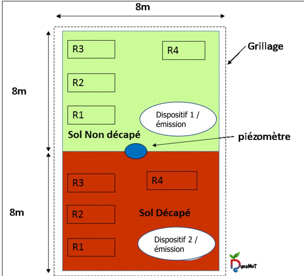
**Figure 4.** Configuration-type d'un exclos de 130 m<sup>2</sup>. R1, R2, R3, R4 : délimitation des 4 réplicats de 6 m<sup>2</sup> chacun. Dispositifs 1 et 2, destinés aux prélèvements des émissions de phytosanitaires provenant du sol, pour des mesures *in situ* intégratives hebdomadaires.
