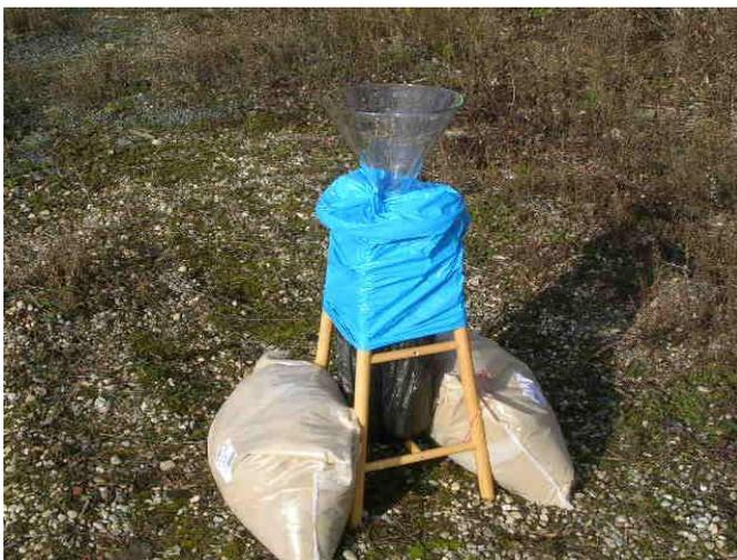
**Figure 7.** Jauge Owen pour la collecte des retombées atmosphériques (Surface de collecte de 0,07 m<sup>2</sup>).
