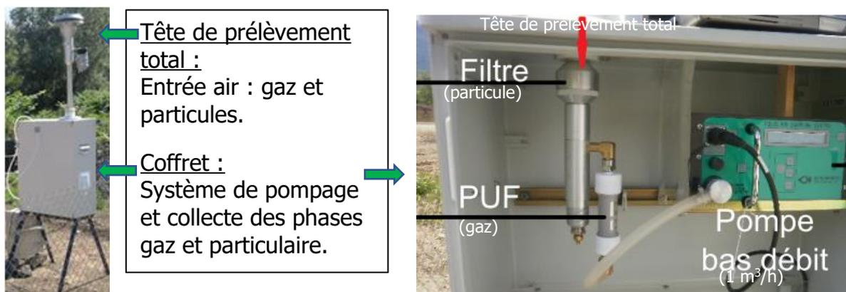
**Figure 8.** Préleveur atmosphérique de particules et de gaz (gauche) avec à l'intérieur un coffret (droite) la pompe bas débit, le porte filtre à particules et le porte mousse (PUF) pour la collecte des gaz. Dispositif sur batterie alimenté par panneau photovoltaïque.
