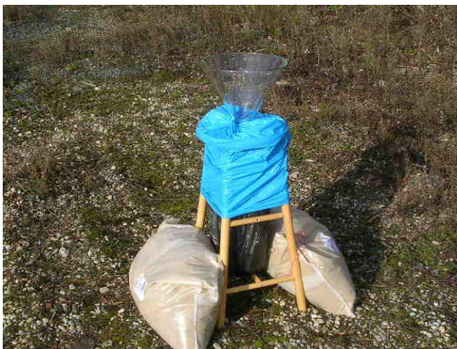
Figure 7. Jauge Owen pour la collecte des retombées atmosphériques (Surface de collecte de 0,07 m 2 ).
