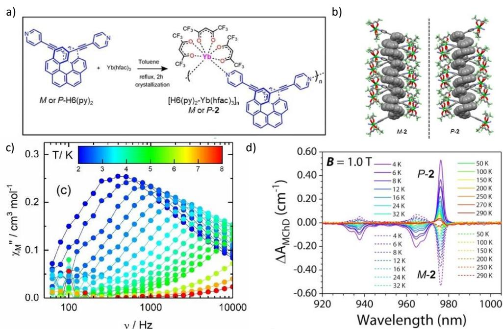
Figure 1 : a) Schéma de synthèse des complexes polymères *M-2* et *P-2* b) Arrangement supramoléculaire des énantiomères *M-2* et *P-2* selon l'axe *a*. c) Dépendance en fréquence de  $\chi_M''$  pour *M-2* entre 2 et 8K sous un champ de 1600 Oe. d) variation en température du spectre MChD (920 - 1005 nm) des composés *M-2* et *P-2* sous un champ magnétique  $B = \pm 1.0T$ . (Schéma adapté de l'article : *Angew. Chem. Inter. Ed.*, 62, e202215558, 2023)
