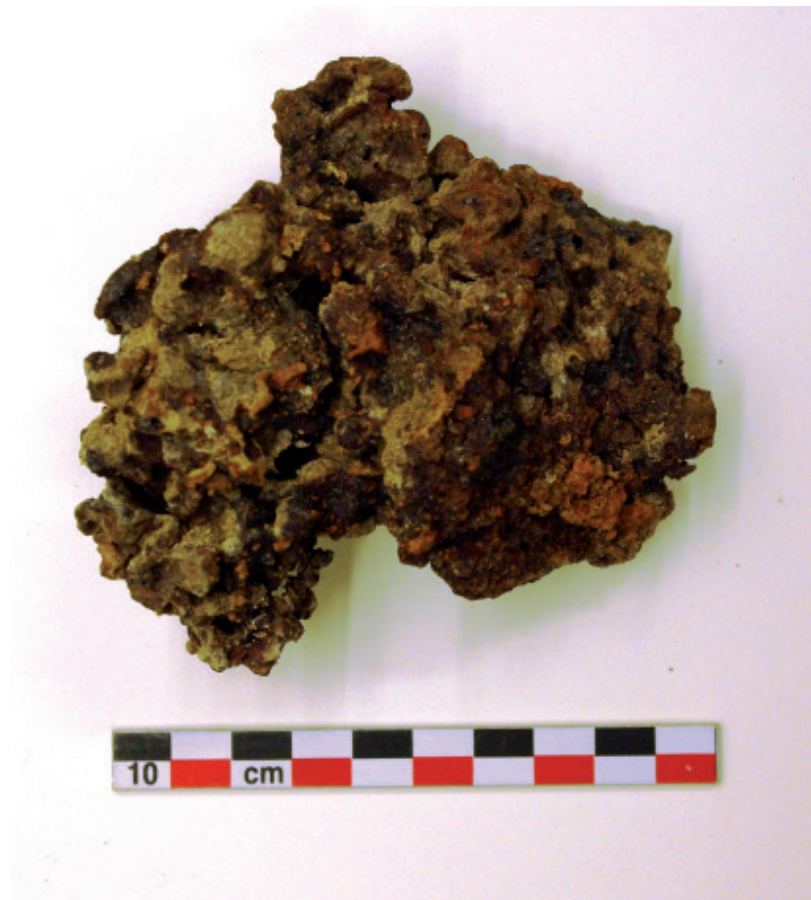
Figure 8. Exemple d'une scorie complète de type SFR 2, issue du silo 1003 (Us.06-5). On distingue de nombreuses empreintes de charbon de bois.
