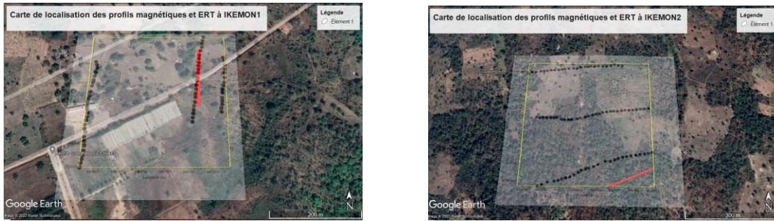
Figure 1 : Cartes de localisation des profils (magnétiques en noir et ERT en rouge) sur Images Google Earth des secteurs Ikémon1 et Ikémon2
