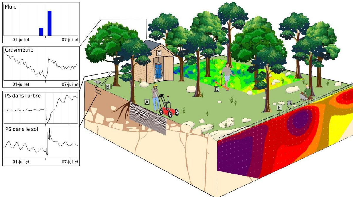
Fig. 1: Mise en œuvre sur le terrain des principales techniques géophysiques abordées. Pour chaque technique, un exemple de résultat est donné : ici, des séries temporelles, des coupes transversales et des cartes. Les méthodes illustrées sont A) le radar à pénétration de sol (GPR), utilisé pour détecter les racines grossières ; B) le potentiel spontané (SP), utilisé pour surveiller l'écoulement de l'eau ; C) la gravimétrie, utilisée pour surveiller les réserves d'eau ; D) l'induction électromagnétique (EMI), utilisée pour caractériser l'hétérogénéité spatiale des propriétés du sous-sol ; et E) la tomographie de résistivité électrique (ERT), utilisée pour caractériser l'hétérogénéité spatiale des propriétés du sous-sol et, éventuellement, surveiller la dynamique de l'eau.
