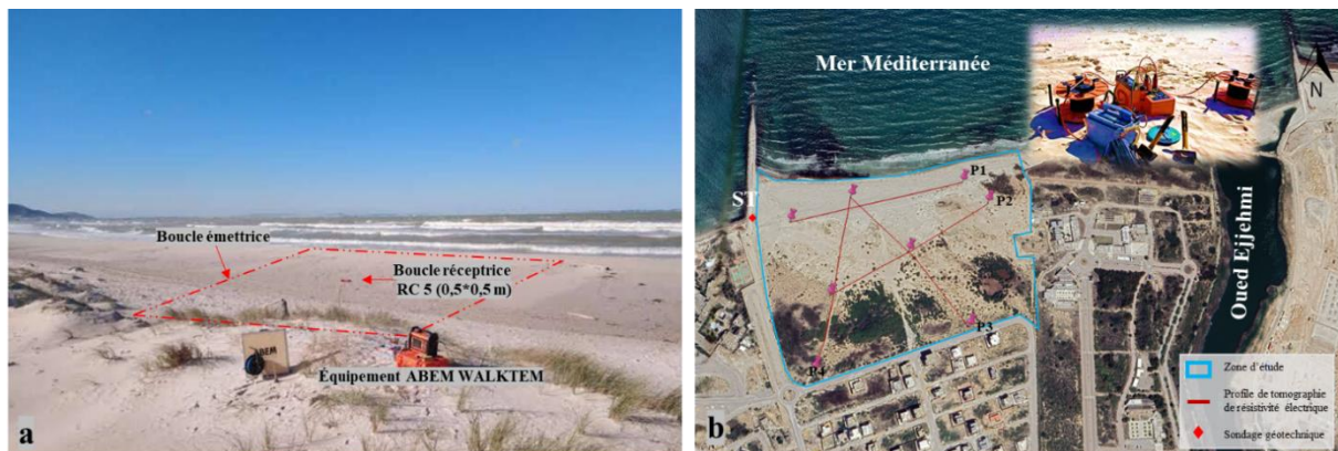
Fig. 2 – a) Photo d'acquisition TDEM avec équipements ABEM WALKTEM sur la côte de Soliman b) Carte de localisation de la zone d'étude et position des profils ERT et du sondage Géotechnique (ST)
