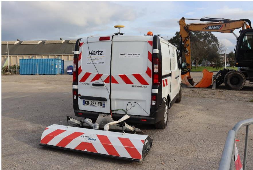
Fig. 1 – Raptor 18-canaux avec positionnement GNSS dans la ville de Cherbourg.
