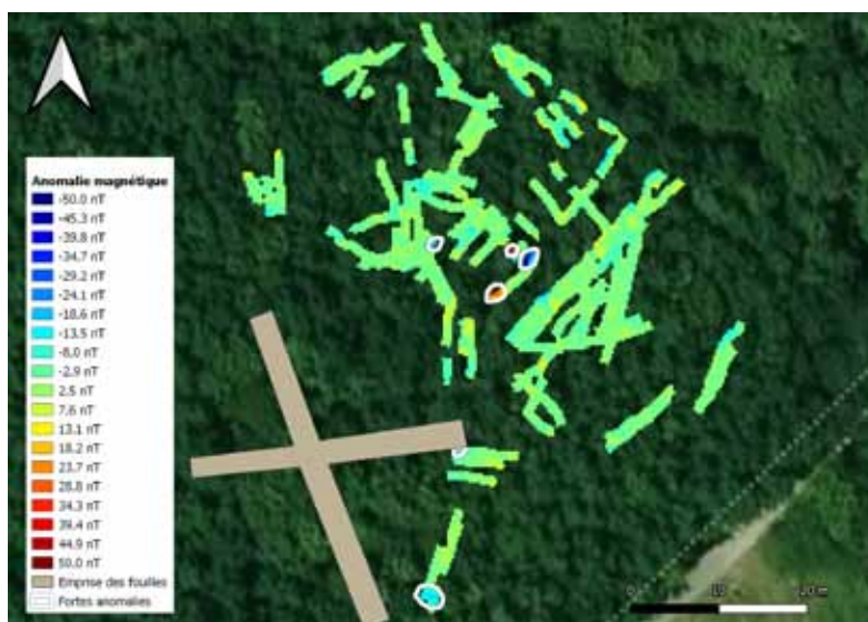
FIGURE 13 – Carte de l'anomalie magnétique sur fond d'image satellite et mise en avant des anomalies les plus importantes.
