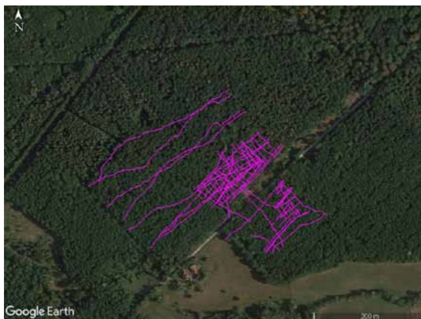
FIGURE 71 – Profils et traverses d’acquisition du 27 février (en rose) au sol drapant la topographie à 1 m sur fond d’image satellite.
