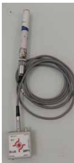
FIGURE 69 – Dispositif d'acquisition échelle large utilisé à Voellerdingen. En bas : dispositif électronique central de type DIEFI. En haut : magnétomètre fluxgate tri-axial (Bartington MAG03)
