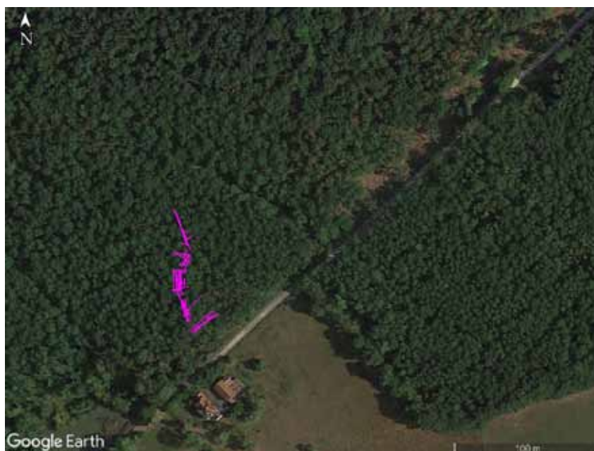
FIGURE 74 – Profils et traverses d’acquisition du 14 février (en rose) au sol drapant la topographie à 1 m sur fond d’image satellite.
