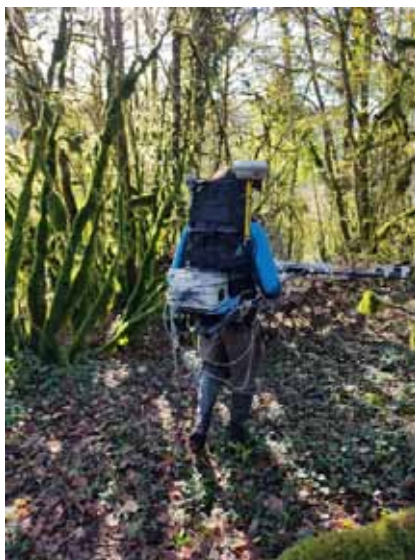
FIGURE 70 – Dispositif d'acquisition échelle détaillée utilisé à Voellerdingen. Photographie prise dans le Jura. Lors des acquisitions à Voellerdingen la perche est tenue verticalement par rapport au sol et non parallèlement comme sur la photographie.
