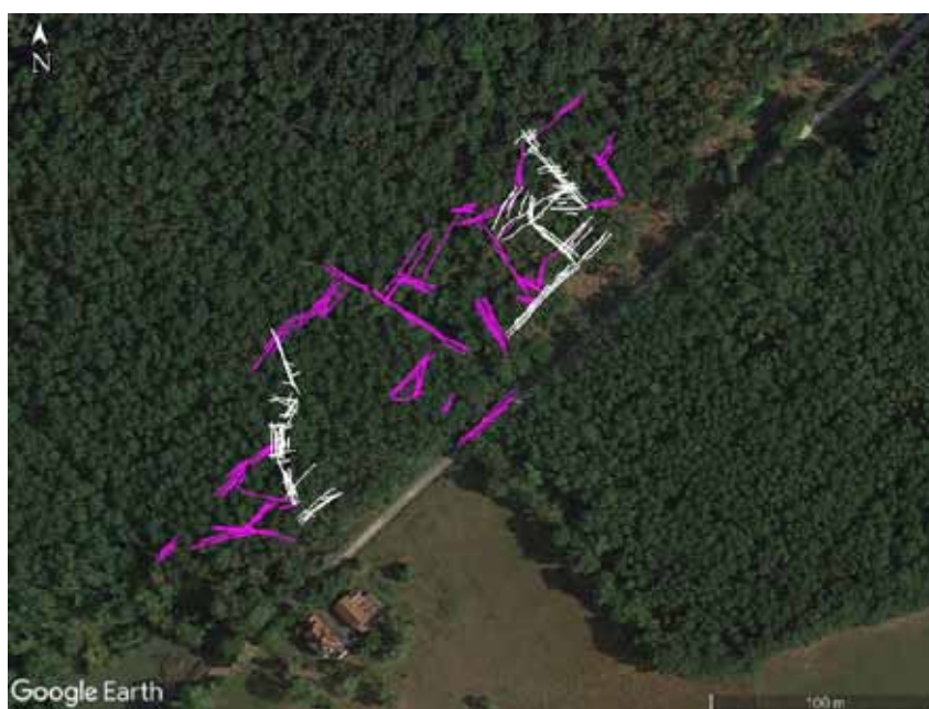
FIGURE 76 – Profils et traverses d’acquisition du 22 février (en rose) au sol drapant la topographie à 1 m sur fond d’image satellite.
