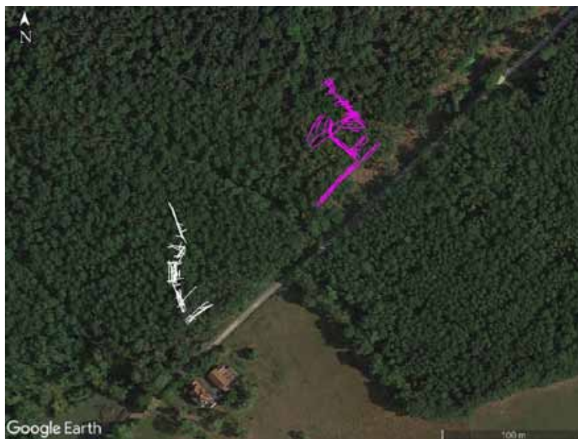
FIGURE 75 – Profils et traverses d’acquisition du 20 février (en rose) au sol drapant la topographie à 1 m sur fond d’image satellite.
