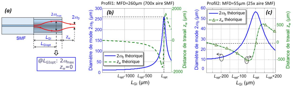
Fig. 1 : (a) Principe de la microlentille SMF GIF. Diamètre de mode et distance de travail en fonction de la longueur de gradient d'indice pour deux profils de GIF, profil 1 (b) et profil 2 (c).
